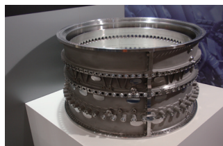
(d) 法国 Aerospace 公司电解加工的机匣
